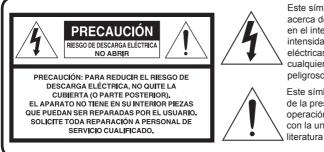
Este símbolo tiene por finalidad alertar al usuario acerca de la presencia de tensión sin aislación en el interior del producto, que puede tener la intensidad suficiente como para causar descargas eléctricas. Por lo tanto, hacer contacto con cualquier pieza en el interior de la unidad es peligroso.
